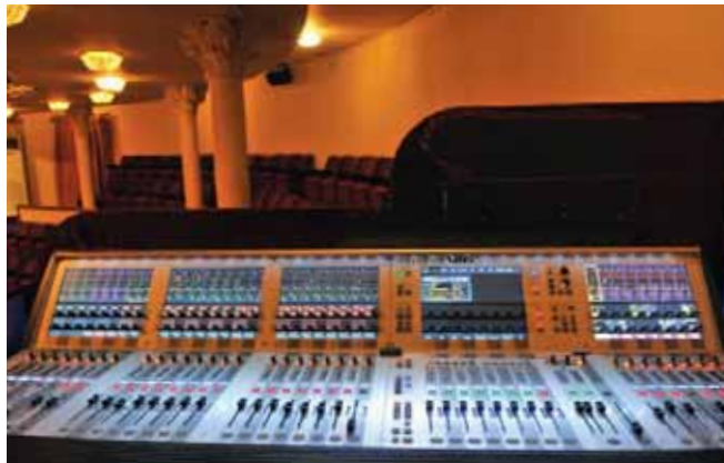
A Soundcraft Vi6 digital foi adquirida recentemente para o West Side Story e actualmente complementa a Cadac F-Type realizando a pré-mistura da orquestra, com a enorme vantagem de que todo o seu processamento integrado permite reduzir a quantidade de equipamento externo necessário e reduzir riscos de erros
