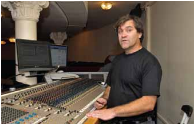
A automação desta Cadac está garantida por dois PCs (um deles funcionando como spare ), segundo nos explica Félix. Isto significa que depois de carregado o espectáculo nas duas plataformas, se pode alternar entre um e outro sempre na mesma cue , para que nada falhe
